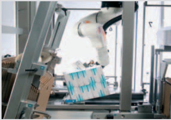
Side Loading Casepacker – mit intelligenter Robotergruppierung für effektive Kartonbefüllung Side Loading Casepacker- with intelligent robot collation for effective case filling
